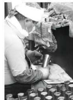
研磨工程 型になったカップを研磨工程できれいに磨き上げます。
