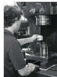
プレス工程 1枚のステンレス版をカップの型に加工している工程です。
